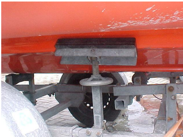
Foto 4: de rubbers moeten de boot goed dragen.
