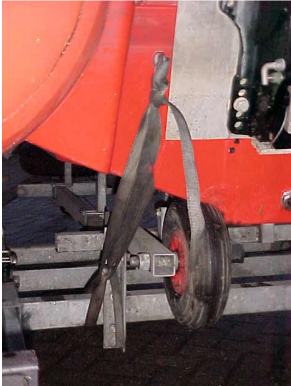
Foto 3: Achterzijde altijd met spanbanden vastsjorren.
