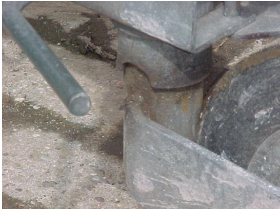
Foto 9: dit wiel is nog niet voldoende opgedraaid
